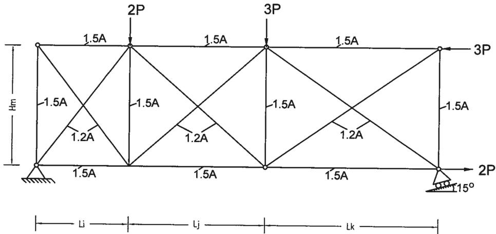
Να επιλυθεί το δικτύωμα του σχήματος με τη μέθοδο της άμεσης ακαμψίας, ακολουθώντας τα εξής βήματα υπολογισμού:
