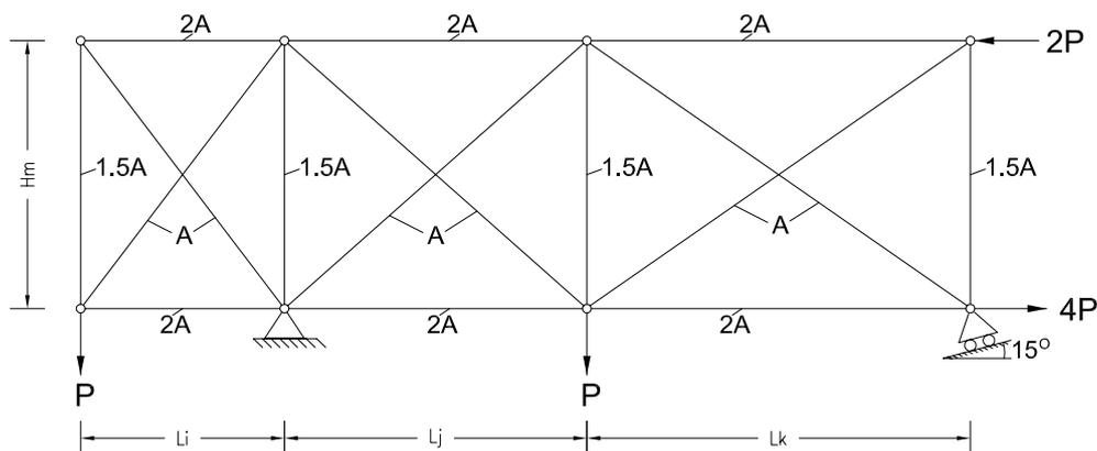
Να επιλυθεί το δικτύωμα του σχήματος με τη μέθοδο της άμεσης ακαμψίας, ακολουθώντας τα εξής βήματα υπολογισμού:
